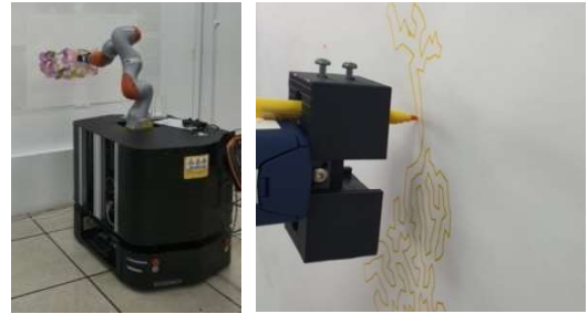
그림 2: 매니플레이터와 모바일 플랫폼이 결합된 로봇
